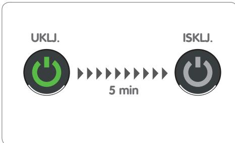
Nakon 5 minuta mirovanja, aparat se automatski isključuje (Ekonomični režim).
