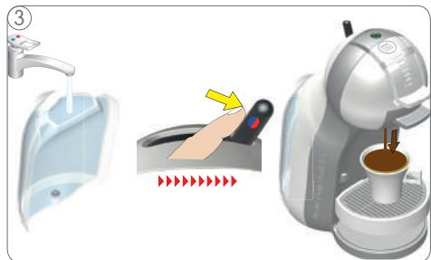
Proverite da li ima vode u rezervoaru za vodu: ako je nema, sipajte je i ponovo pomerite polugicu u poziciju vruće/hladno da biste nastavili s pripremom; ako vode ima, nastavite na sledeći način:
